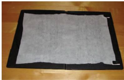
Figure 20 : Capteur électrostatique de poussière (EDC)
